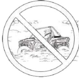
Помните, что эффективность мокрых тормозов снижается. После прохождения водной преграды проверьте тормоза. При необходимости несколько раз нажмите на рычаг тормоза. Это поможет высушить тормозные колодки.
