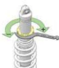
Для регулировки предварительной затяжки выполните следующие действия:
