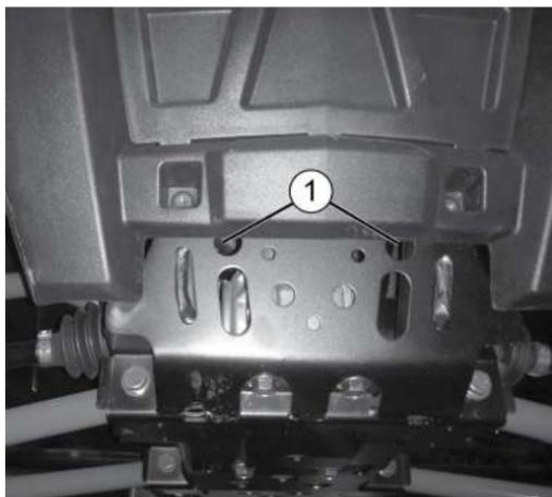
1 2 передние точки крепления при транспортировке
