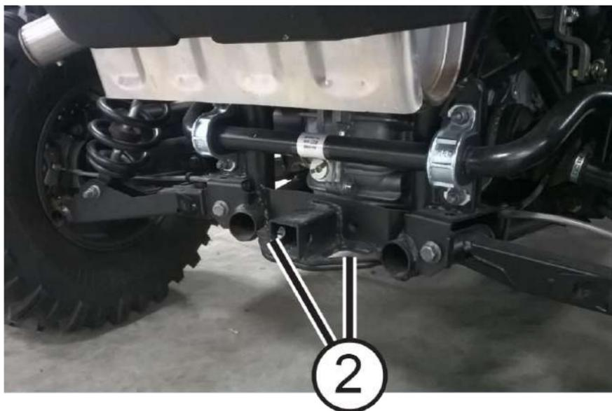
2 2 задние точки крепления при транспортировке (или буксировочная петля)
